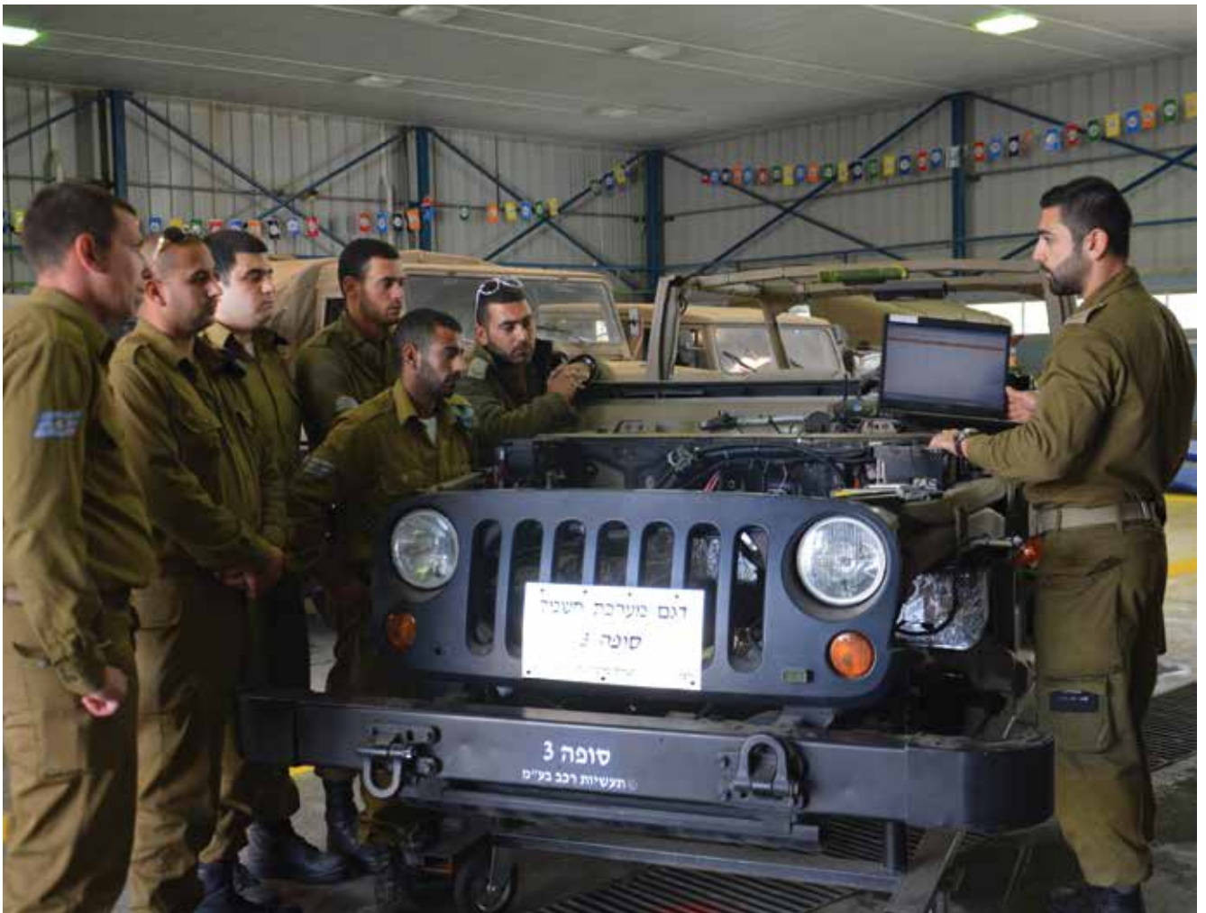
הדרכה על רכב סופה 3 לאיתור תקלות באמצעות ציוד בדיקה מתקדם | אחזקת המערכים הטכנולוגיים הופכת למורכבת יותר ויותר
