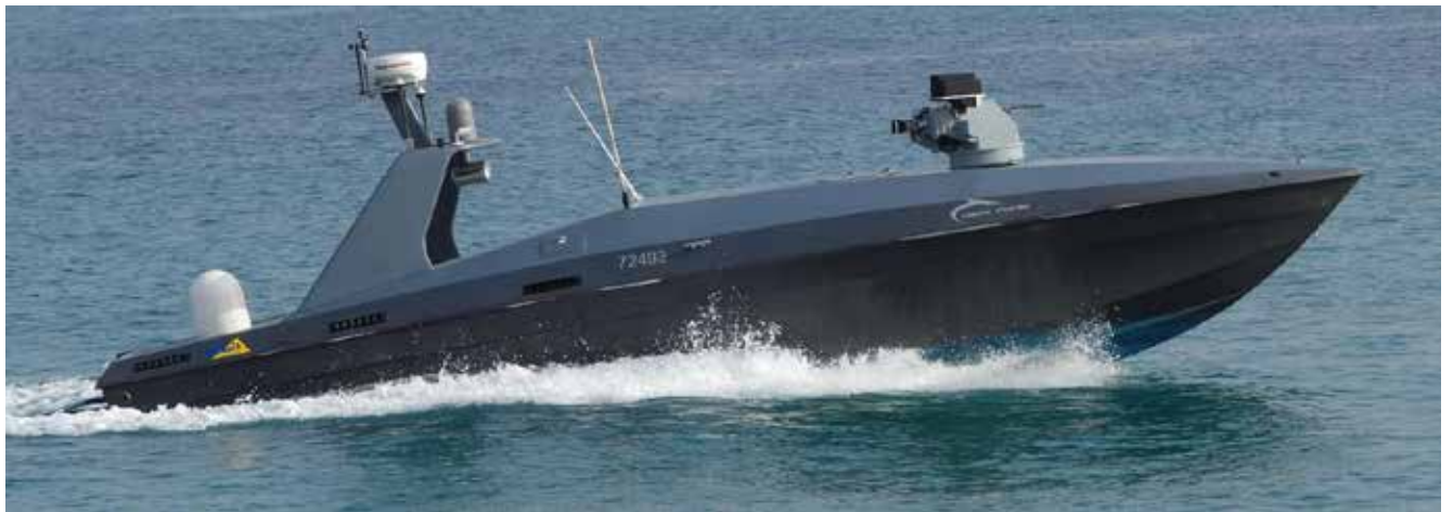
כלי שיט לא מאויש מדגם סילבר מרלין של אלביט מערכות | כלים ימיים בלתי מאוישים מסוגלים לשאת מטען גדול יותר, ויש להם כושר עמידה רב יותר מאשר לכלים בלתי מאוישים אחרים
