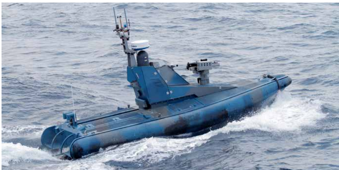
כלי שיט בלתי מאויש מדגם פרוטקטור של רפאל | כלי שיט בלתי מאוישים משמשים בעיקר למשימות שיטור בים בעזרת אמצעי תצפית שונים
