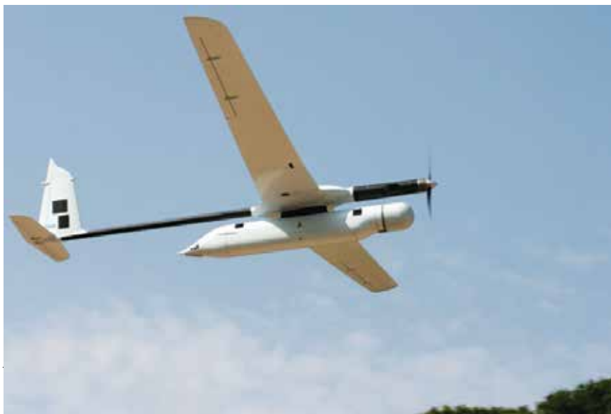
המל"ט סקייילארק של חברת חץ הכסף | נוסף על עסקאות עם התעשייה האווירית רכשה צרפת גם את המל"ט סקייילארק מחברה-בת של אלביט לשימוש הכוחות המיוחדים שלה. המל"ט מיועד למשימות סיור ואיסוף מודיעין לטווח של עד 10 ק"מ ("מעבר לגבעה" בלשון המקצועית)
