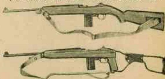
רובה-קסינאי של הרגלי החדש. שרבוני אמריקאי. למעלה — הסיפוס הרגיל. למטה — לשימוש צנחנים (עם קת מחקפלת).
