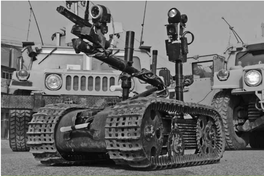
כלי רכב בלתי מאויש מדגם טאלון של חברת קינטיק פוסטר-מילר. הכלי מסוגל לבצע מספר רב של משימות, ביניהן סילוק פצצות, איסוף מודיעין ואף ירי בשליטת מפעיל מרחוק
