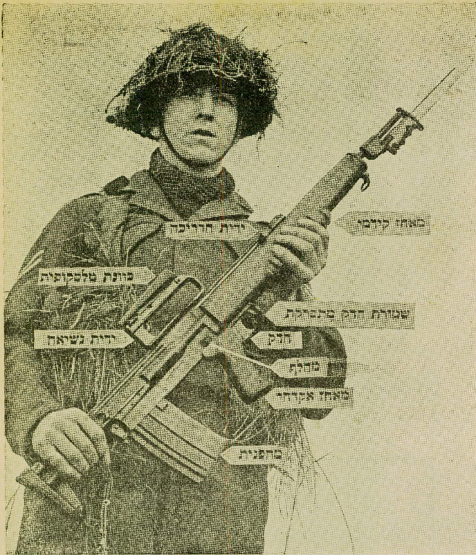
הרובה המטען כשכידונו מוצמד שיס-לב: לכונת הטלסקופית על ידית הנשיאה; למחסנית הגדולה; למחלק, המאפשר יריה אבטומטית ובודדת
