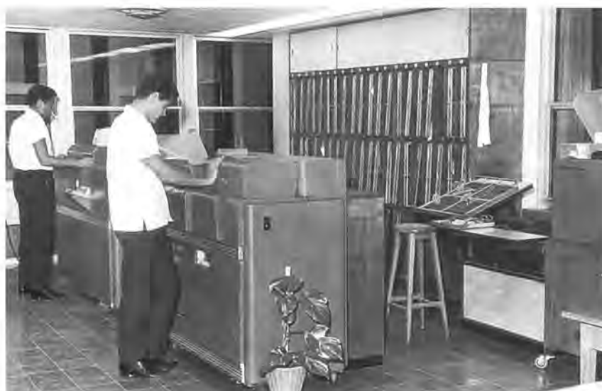
ציוד קונונציונלי: מלווחות בממ"ס - מכונות המתרגמות את החירור בכרטיסים המנוקבים ומעבירות את תוכנם על גבי נייר
