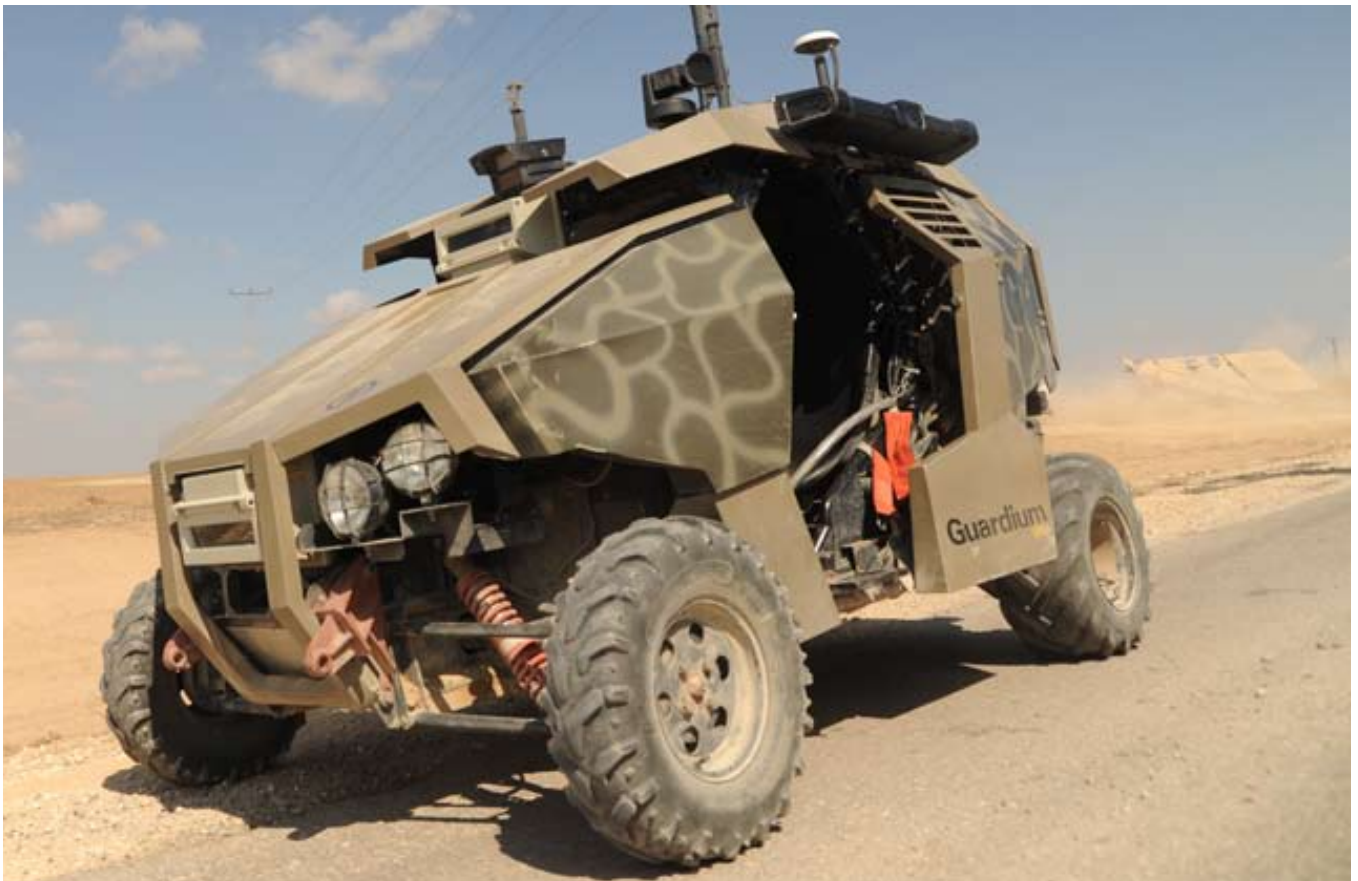
"גרדיום": רכב אוטונומי (בלתי מאויש) של צה"ל על גדר הגבול ברצועה. רכבים עתירי סנסורים הפכו זה מכבר לסטנדרט בתעשיית הרכב, כחלק ממהפכת הרכב המקושר
