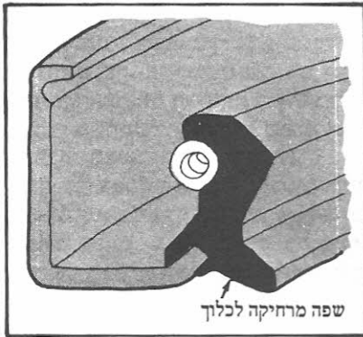
ציור 3 — אטם-שמן בעל-קפיץ, בעל שתי שפות-אוטמות המגופרות בבית-מתכתי פתוח.
