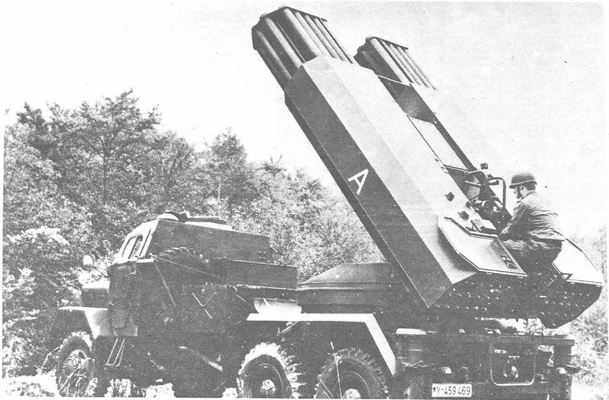
בתמונה — LARS-110 — ה"מטר"ק המבצעי היחיד במערב-אירופה נמצא בשימוש צבא מערב-גרמניה מאז 1970. בעל 36 קנים לשיגור רקטות 110 מ"מ לטווח מקסימלי של 14 ק"מ.
