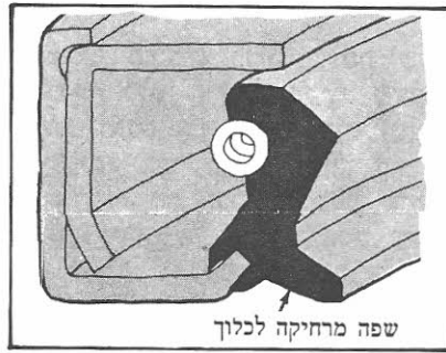
ציור 5 — אטם-שמן בעל-קפיץ, בעל שתי שפות-אוטמות המגופרות בבית-מתכתי סגור.
