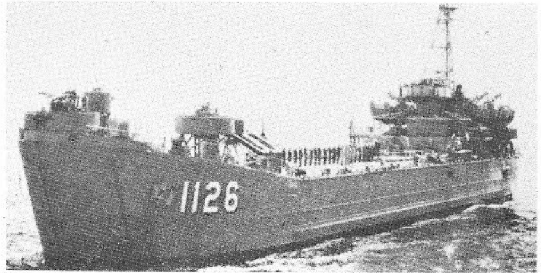
נחתת-טנקים אמריקנית (Landing Ship Tanks), בעלת 1650 טונות. מסוגלת לשאת 40 טנקים. מהירותה 11 קשר. חימושה — 8 תותחי 40 מ"מ.
