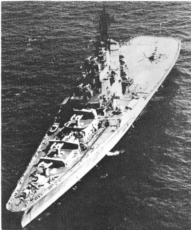
נושאת המסוקים הסובייטית "מוסקוה" (Moskva), בעלת 18-000 טונות-אורכה כ-200 מטרים ומהירותה המירבית 30 קשר. היא מיועדת לשאת 30 מסוקים. חימושה — טילי ים-אוויר, רקיטות נגד צוללות ותותחי 57 מ"מ נגד מטרות שטח ואוויר.
