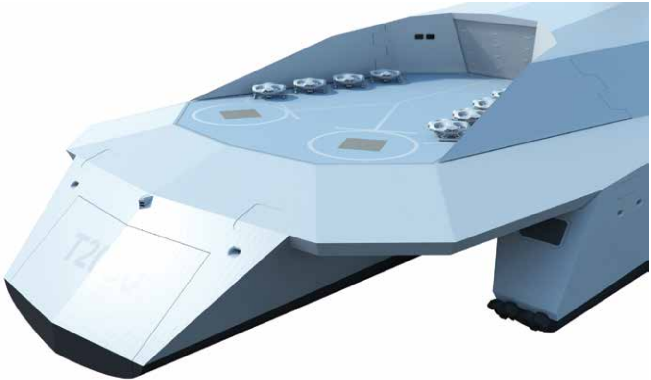
נחנת המשמש להמראה ולנחיתה של רחפנים אוטונומיים ושל כלי טיס מאוישים (הדמיה מתוך פרויקט "dreadnought 2050")
