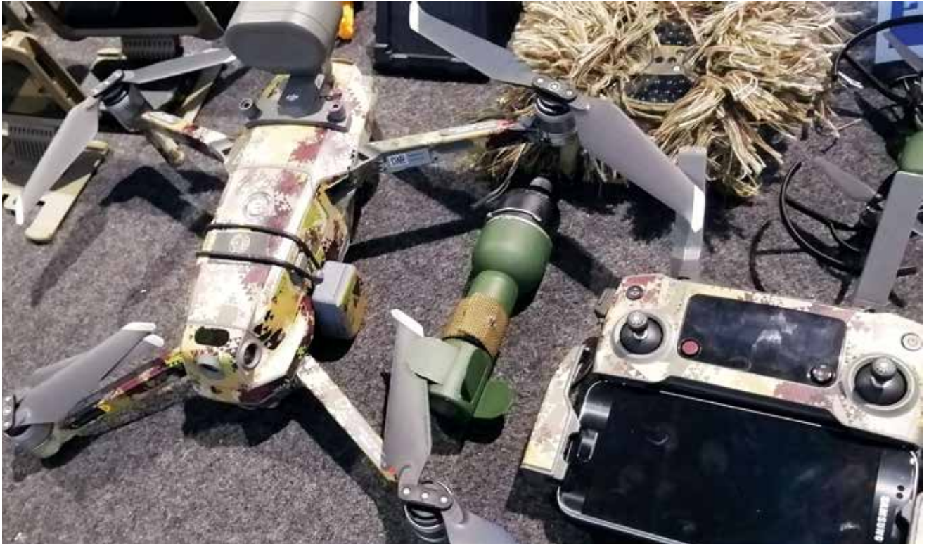
רחפן פשוט שהוסב לרחפן נושא חימוש (רימון). לשימוש ברחפן מטיל יתרונות בולטים, המפצים על חסרונות כמו טווח פעולה קצר ומשקל נשיאה מועט. צילום: ויקיפדיה
