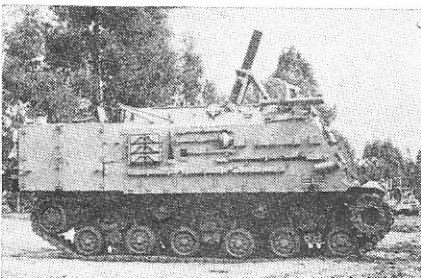
המרגמה הכבדה המתבנייעת 160 מ"מ נחשבת לגדולה מסוגה בעולם. פיתוחה הינו מקורי לחלוטין וצבאות רבים, על-אף נסיונותיהם, לא הצליחו לנייד מרגמת כבדות.
