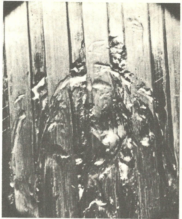
קנה 155 מ"מ ראוי לשימוש — על-אף ששני שדות הקנה פגומים באורח קשה ושניים פגומים קל; כ-60 ס"מ מקצה-הלוע.
