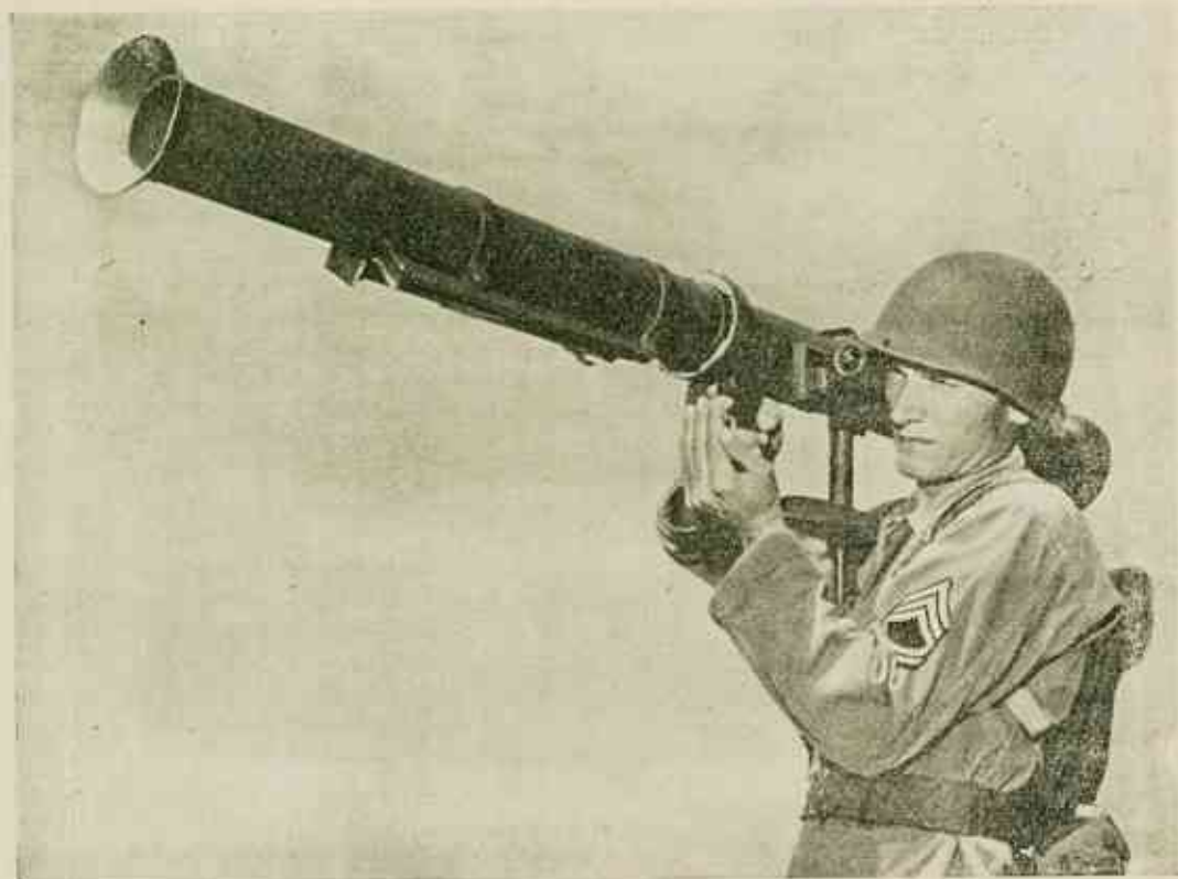
הבזוקה האמריקאית החדשה בקוטר 3½ אינץ'. העולה בהרבה בכושר החזירה שלה על „הבזוקה הישנה. מימי מלחמת העולם בקוטר 2.36 אינץ'. את הבזוקה החדשה אפשר להפעיל דק מן הכתף (כפי שמודגם בחמונה), או מעל פני הערקע, בעזרת דורגל (הנראה בצילום כשהוא מעופף לפניו).
