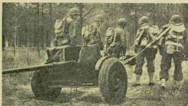
התותח הנ.ט. האמריקאי בן ה-105 ס"מ, הוכנס לשימוש לפני פרוץ מלחמת העולם השנייה. יעיל כנגד מנקים קלים או בינוניים בלבד. מהירות הלוע בין 750 ל-850 מ' בשנייה, בהתאם למוני הפגזים הזדרי-השדיריק השניים. משקל הפגז 2 ליטראות.
