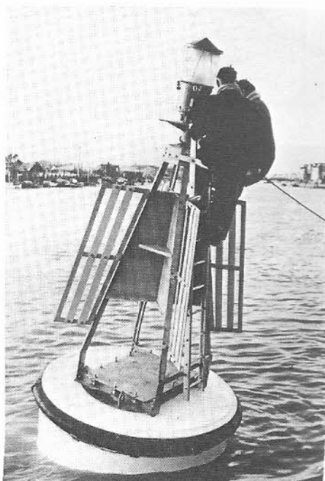
מצוף חדש ורב-תכליתי לנשיאת מעמס עד 3 טונות. גובהו 2 מטרים והוא עשוי זכוכית מעורבת בפלאסטיק.
