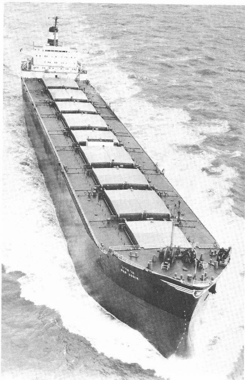
א/מ "הר אדיר" — אוניית תיפזורת בעלת 77,250 טונות מעמס. מהירותה 15 קשר וצוותה מונה 32 איש.
