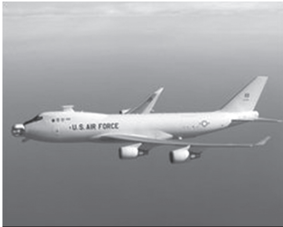
מטוס מטען מסוג בואינג 747-400 שעבר הסבה למטוס מטען הנושא בחרטומו לייזר COIL המיועד ליירוט טילים בליסטיים בשלב ההאצה
