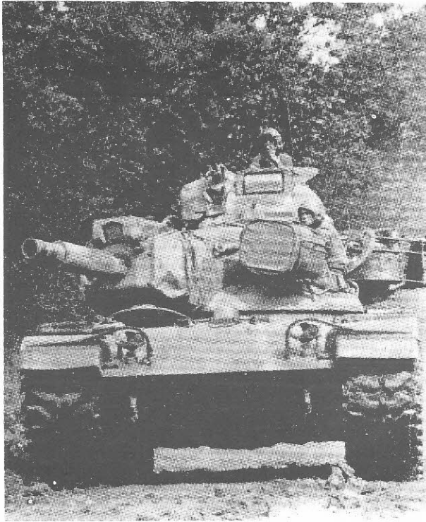
בתמונה — הטנק האמריקאי M60A1E2. בדגם זה של ה-M60 מותקן תותח 152 מ"מ היורה טילי שיללה וכדורים רגילים. הטנק מצויד במערכת ייצוב-תותח מתוצרת קדילק-גיגי ובמערכת בקרת ירי משוכללת עם מחשב ומד-טווח לזר.
