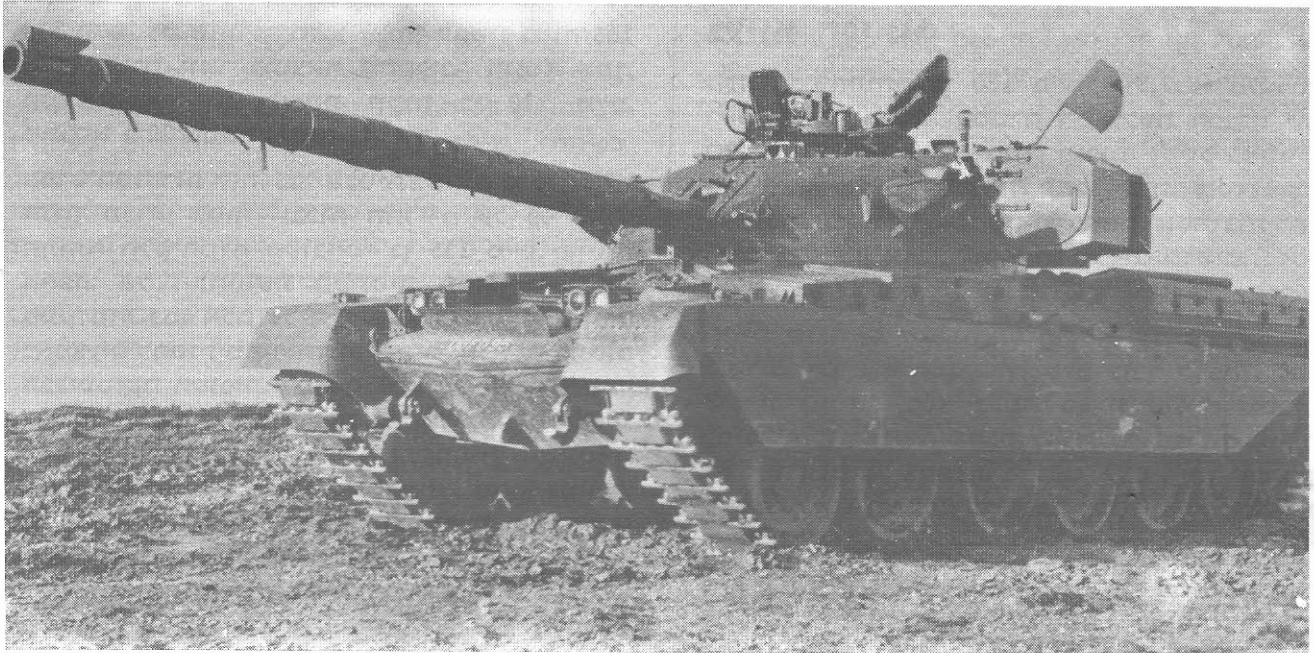
בתמונה — הטנק הבריטי ציפטיין MK5. מרכיב העוצמה הגדול ביותר של הטנק הזה הוא הקנה המחורק בן 120 מ"מ המותקן בו. מערכת בקרת-הירי החדשה שבה מצויד הטנק מאפשרת לנצל בצורה יעילה את הפוטנציאל הגלום בקנה הזה.
