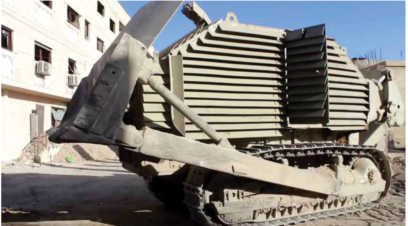
דחפור עם מיגון "תער". חיילי צבא אסד עשו שימוש בדחפורים תעשייתיים (אזרחיים) ליצירת הסוללות, תוך מיגונם בלוחות ברזל מאולתרים
