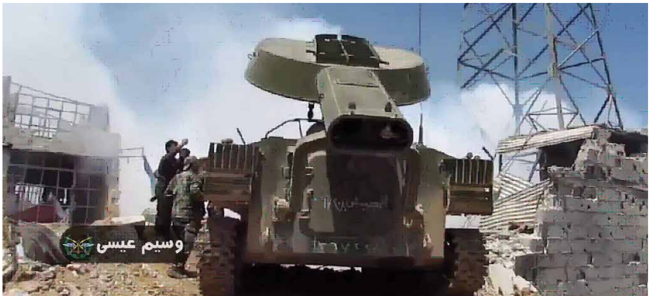
רכב מינוי מוקשים סובייטי מסוג UR-77 בפעולה. די להתבונן בכל אחת מההתקפות שערך צבא סוריה כדי להבין את חשיבותם המכרעת של כלי ההנדסה ואת תרומתם ללחימה
