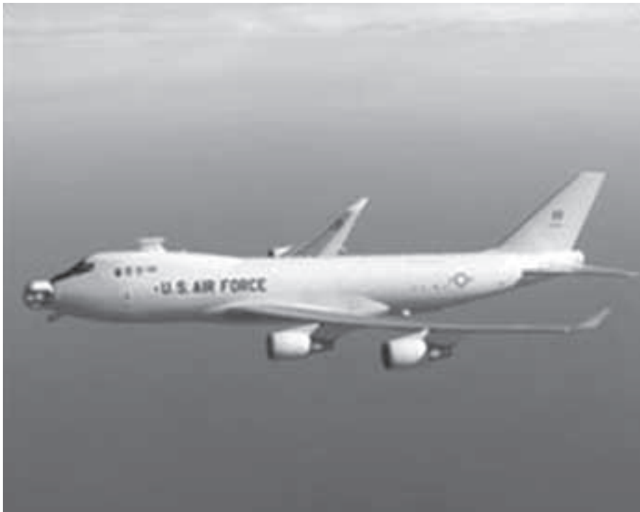
מטוס מטען מסוג בואינג 747-400 שעבר הסבה למטוס מטען הנושא בחרטומו לייזר COIL המיועד לירות טילים בליסטיים בשלב ההאצה
