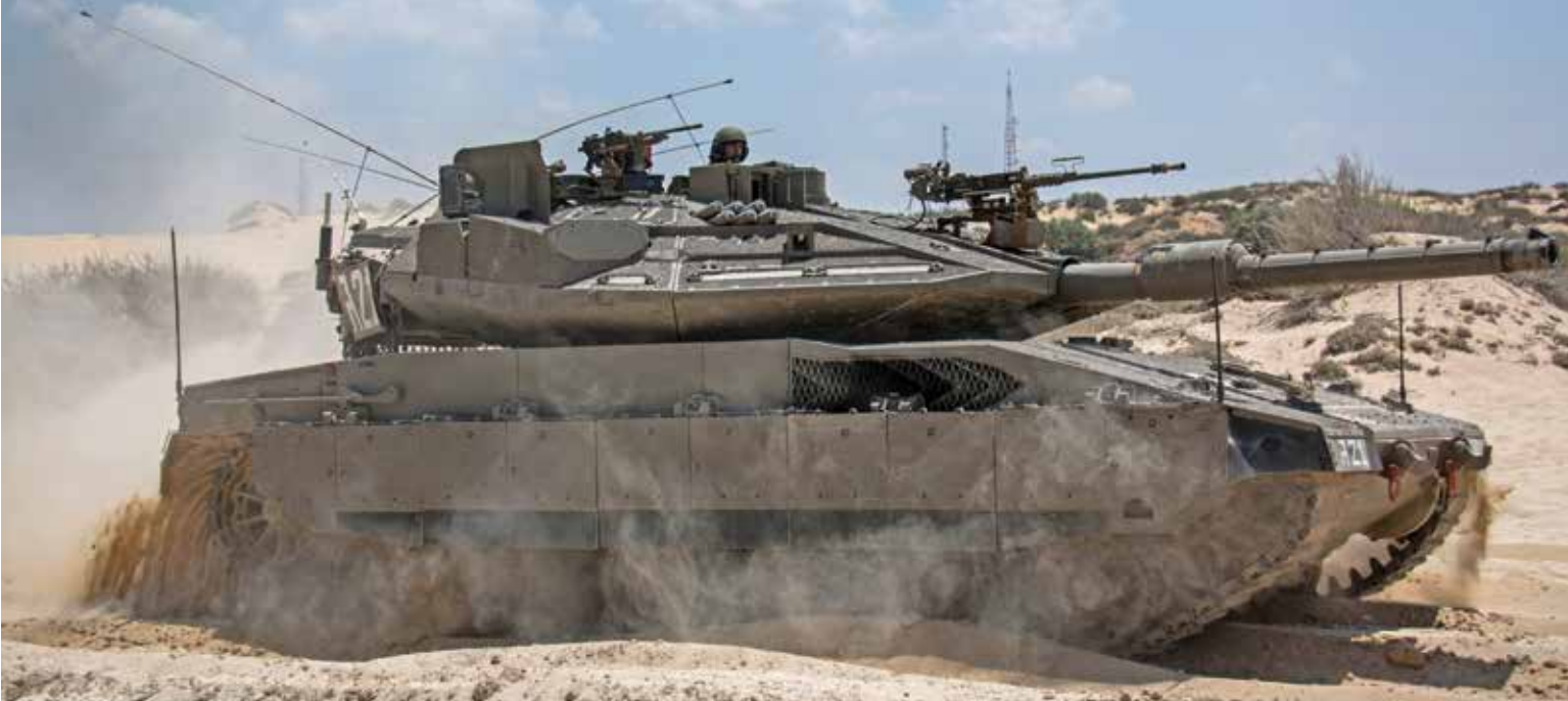
נוק מרכבה סימן 4 עם מערכת הגנה אקטיבית מעיל רוח בזמן מבצע "צוק איתן" | פריצת דרך בתחום המכ"ם היא מערכת מעיל רוח שפיתוחה החל בסוף שנות ה-80 של המאה הקודמת, ומלחמת לבנון השנייה שימשה זרז לפיתוחה ולרכישתה על ידי צה"ל
