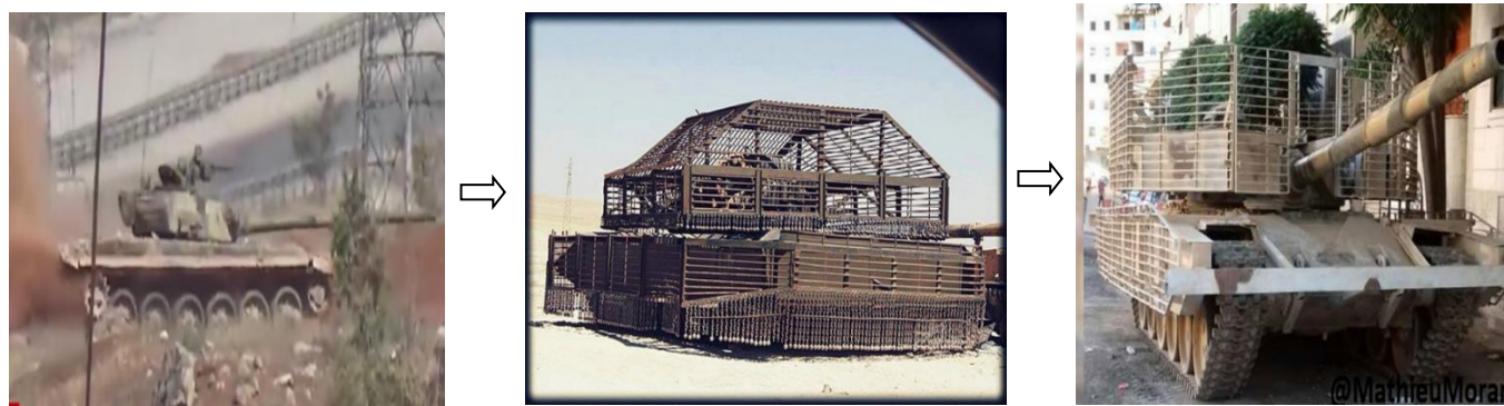
התפתחות מיגון הטנקים באוגדה 4 : משמאל טנק בעמדה בקרב, במרכז גרסה לא מבצעית, מימין טנק בסיום תהליך המיגון
