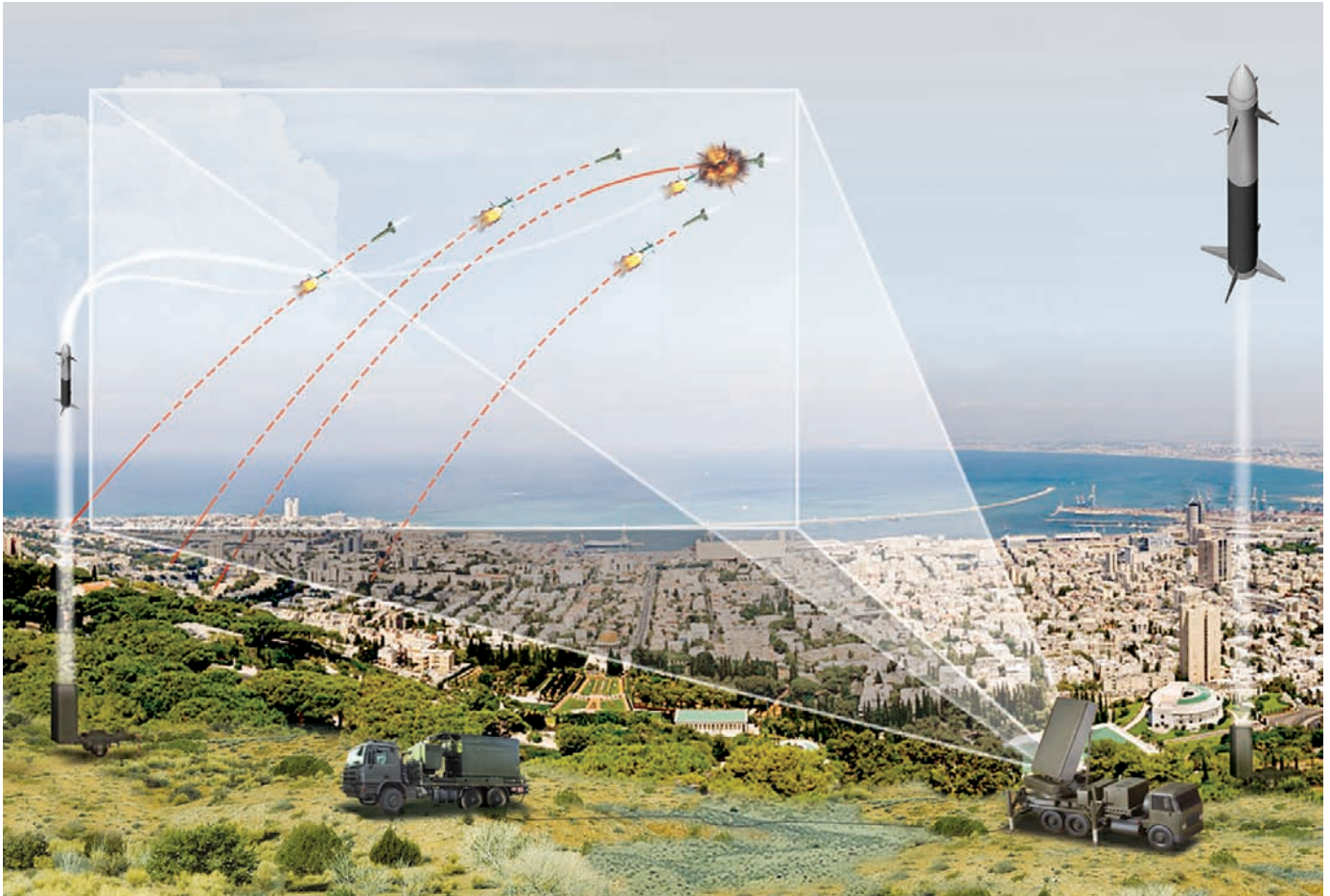
איור המציג את דרך הפעולה של מערכת כיפת ברזל | ההתגוננות בפני טילים בליסטיים ורקטות כולל כמה נדבכים: הרתעה, יירוט באמצעות טילים נגד טילים, שיבוש הכיחות של הטיל, שדרוג המיגון הפסיבי ופיזור תשתיות על פני שטחים נרחבים האיור באדיבות רפא"ל
