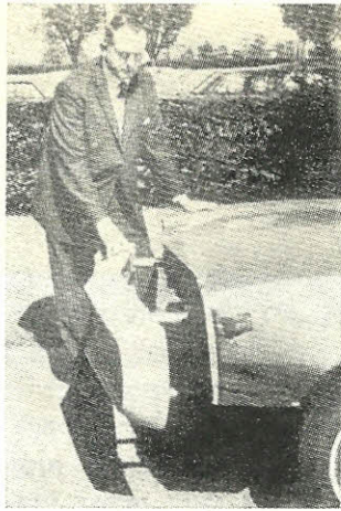
ציור 7: מהנדס של חברת G.M. מציג את הפגוש הניסויי של ה"קמארו". הפגוש מסוגל לעמוד בפני התנגשויות חזיי תיות עד 15 קמ"ש, כפול מהנדרש בחוק האמריקני.
