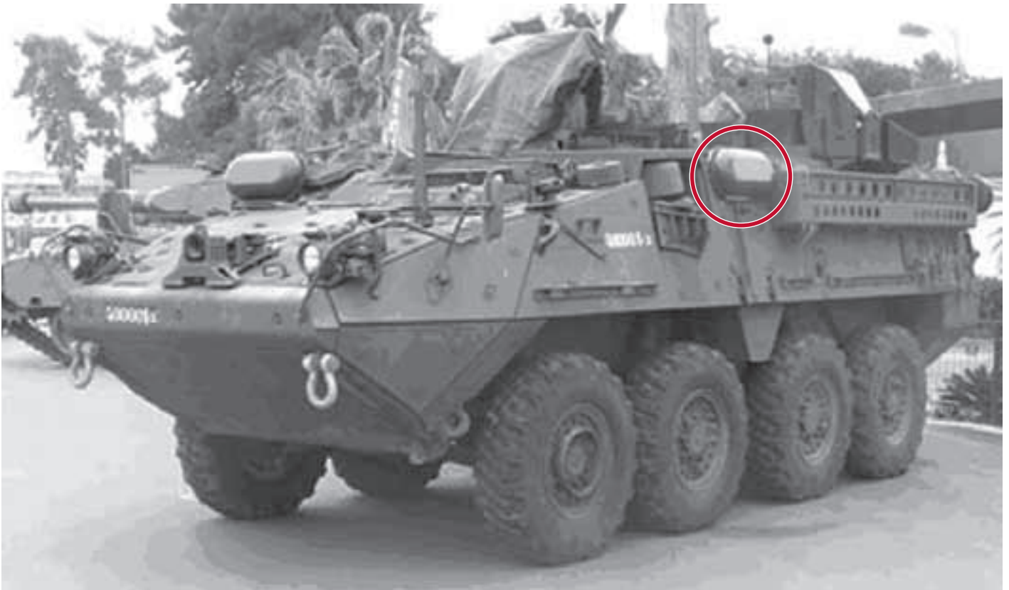
מערכת מעיל רוח מותקנת על נושא גייסות אמריקני מדגם סטרייקר. המערכת כוללת מכ"ם לגילוי טילים נגד טילים (מוקף בעיגול) | למערכת מכ"ם המשולבת ברק"ם תהיה תרומה גם ליכולתו של כוח שריון להתגונן מפני איומי נ"ט - אם באמצעות השמדת מקור הירי מייד לאחר ירי הטיל הראשון ואם באמצעות מתן התרעה לצוות הרק"ם המותקף
