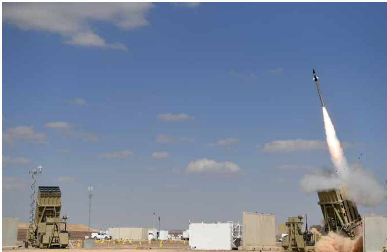
משגרים של כיפת ברזל ומירט המשוגר לעבר מטרה בעת ניסוי פיתוח של המערכת בתחילת 2021. כדי לשמור על ביצועי המערכת בהתאם להתפתחויות, נדרשים סבבי פיתוח מחזוריים וניסויי פיתוח, ולאחר מכן פעילויות הטמעה והכשרה לדרגי השדה בצה"ל המפעילים את המערכת ומתחזקים אותה (צילום: משרד הביטחון)
