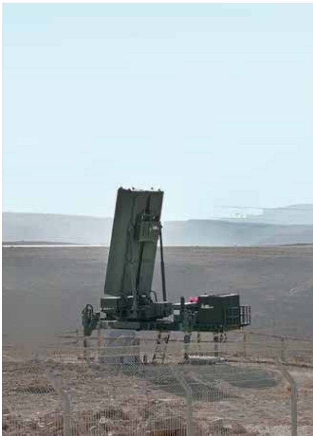
המכ"ם של כיפת ברזל, המגלה את האיומים ועוקב אחריהם עד יירוטם, בניסוי פיתוח של המערכת (צילום: משרד הביטחון)
